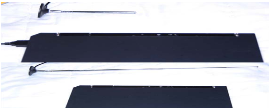
안테나 길이와 노트북 길이의 비교. 노트북의 가로 길이는 27cm, 안테나를 접었을 때엔 12.3cm, 안테나를 늘렸을때는 45.75cm가 된다.
